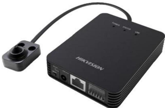
Discrezionalità e definizione si uniscono in un'unica telecamera, generando riprese video di elevata qualità. Per quelle applicazioni dove viene richiesto il dettaglio del particolare e contemporaneamente poter collocare il punto di ripresa in zone nascoste, Hikvision propone le telecamere "Covert" a risoluzione 1.3 Megapixel a 25fps con ottica fissa *Pin-Hole* da 3.7mm.
