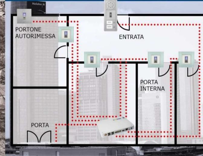
**EKEY home** è una soluzione stand-alone, senza rete e server: **1 lettore d'impronte** collegato a **1 centralina di comando**. Si possono aprire fino a 3 porte/cancelli, attivare l'allarme o controllare la house automation. Diverse varianti di centraline e modelli di lettori.
