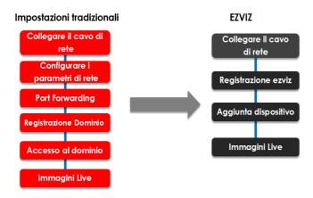
Nei dispositivi che supportano il servizio "EZVIZ", la procedura di registrazione risulta semplificata, in quanto non è più necessario eseguire alcuna configurazione di port mapping. Questo significa semplificare e ottimizzare notevolmente i tempi per l'installazione.
