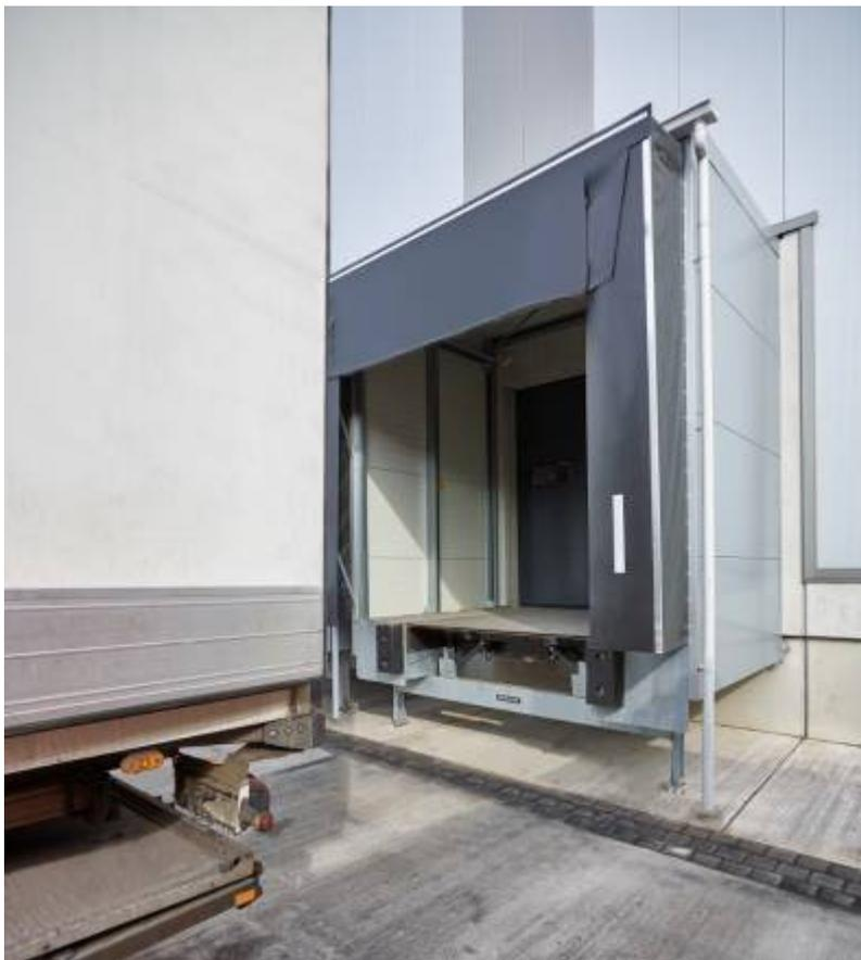
**Figura 6:** i boccaporti prefabbricati Hörmann sono dotati di pannelli con struttura 'a sandwich' a doppia parete da 60 mm sulle pareti laterali e sul rivestimento tetto. Essi proteggono dagli agenti atmosferici e riducono la trasmissione di rumore durante le operazioni di trasbordo merci.
