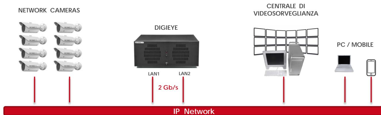
Nuove modalità avanzate che offrono i seguenti vantaggi: **PRESTAZIONI** fino a 2 Gb/s, **SICUREZZA** con separazione delle reti dedicate a telecamere e centralizzazione, **AFFIDABILITA'** in caso di malfunzionamenti degli apparati di rete (high-availability)
