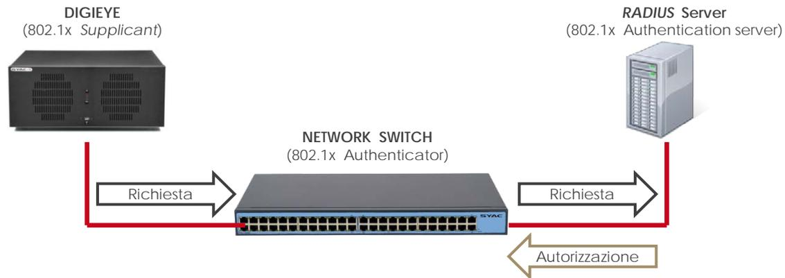
Lo standard 802.1x prevede che ciascuna porta connessa fisicamente alla rete sia autenticata da un server dedicato (tipicamente un server *Radius*), eliminando la possibilità di un accesso non autorizzato tramite collegamento fisico alla rete.
