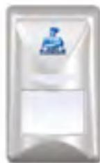
Rivelatore vol. doppia tecnologia composto da sez a Microonde (MW) e sez Infrar. Passivo (PIR) per installazioni altamente professionali. Sistema GLAS (Global Ant imasking System), con Antimasch. su MW, Antimasch. Attivo su IR, e sistema ABP1 / ABP2 (anti occultamento dell'intruso). Set di resistenze DEOL di fine linea per singolo e triplo bilanciamento. Port. 18m
